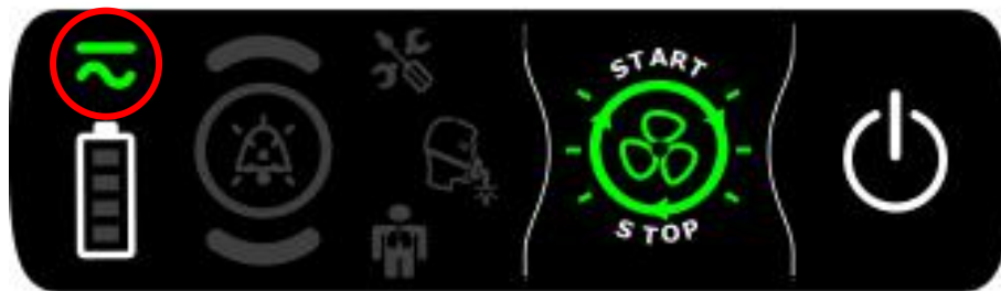
Tastenfeld des Beatmungsgeräts – Stromversorgung durch den EO-BAT9
