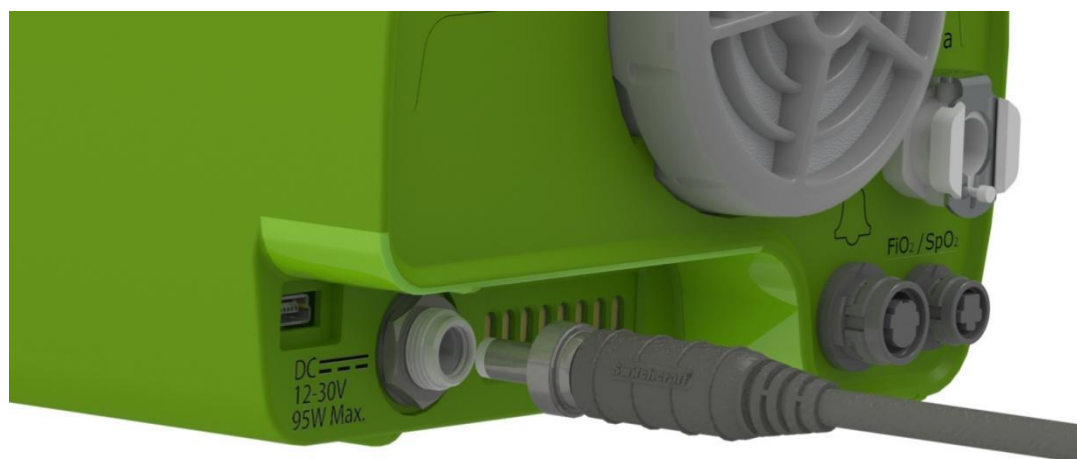
Connecteur de charge côté EO-150
