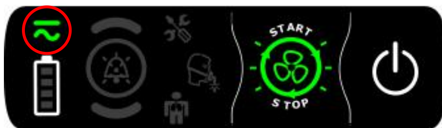
Tastiera del ventilatore - EO-BAT9 alimenta il ventilatore
