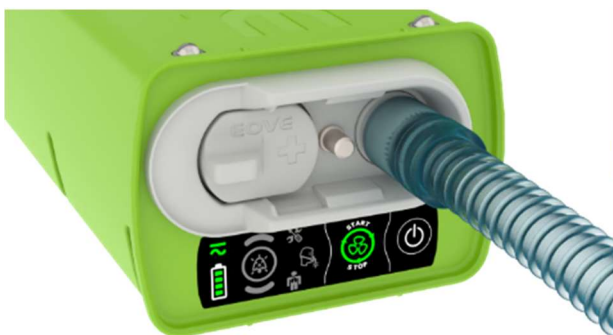
Proximális szabad dugóval EO-LMP2 (EO-DB2-1P kezelőfelületen)
