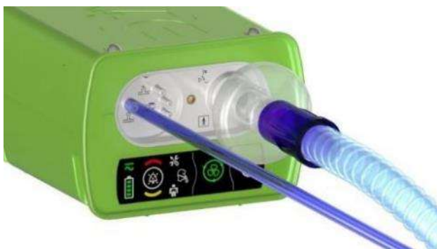
Proximális nyomás adapterrel
