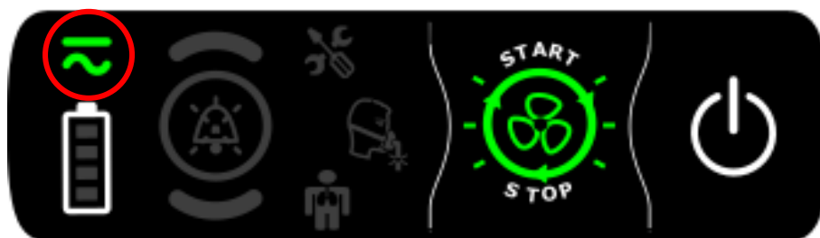
Ventilatorens tastatur – EO-BAT9 som levere strøm til ventilatoren
