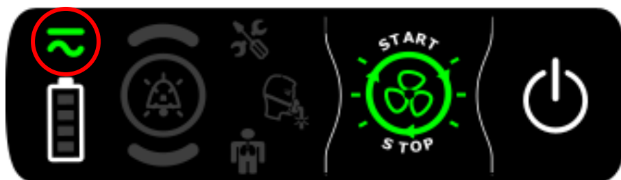
Klávesnice dýchacího přístroje - EO-BAT9 napájí dýchací přístroj
